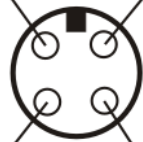
D0: M12 Stecker 4pol, MU Pin 1(+), Pin2 (4-20 mA), Pin 3+4 nc
